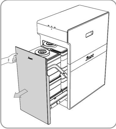
2. 原水タンクの取っ手を取り二つの原水タンクを取外してください。
