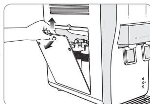
3. 古いフィルターの継手を外します。古いフィルターをフラッシング済みの新しいフィルターと交換します (適切な工具を使用して継手を外します)。
