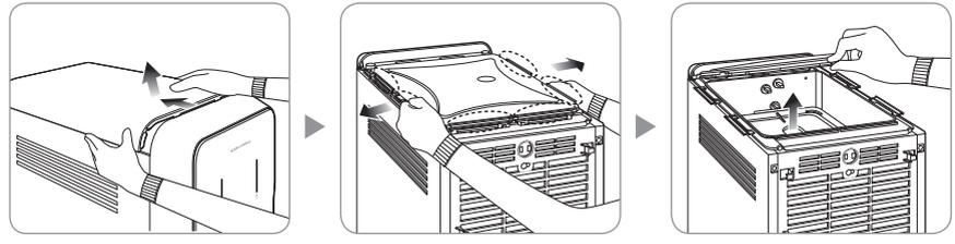
4. 内部貯水タンクの蓋から抗菌フィルターを取り外し、バケツに受けた水の中で振って洗います。
