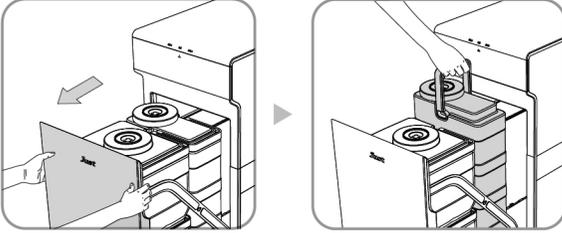
2. 廃棄水タンクのふたを反時計方向に回して分離します。廃棄水タンクに水をすべて捨て、ふたを時計方向に回し、しっかり閉めます。
