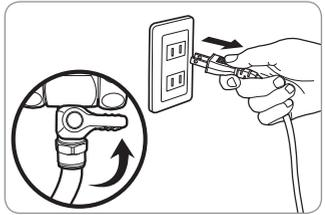
2. 排水ホースを使用して、浄水器内部の水をすべて完全に排水します。
