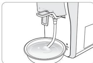
7. 上部カバーを閉じ、電源プラグを接続してから原水バルブを開きます。水が抽出口から出ることを確認してから、冷水機能をオンにします (浄水器の使用方の説明は9ページを参照してください)。
