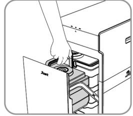
2. 原水タンクのふたを反時計方向に回して分離します。原水タンクに水道水を水位表示線まで入れ、ふたを時計方向に回し、しっかり閉めます。
