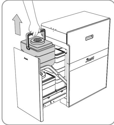
3. 原水タンクのふたを反時計方向に回して取外します
