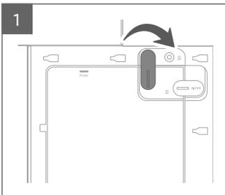
1 サイドカバーを開け、固定レバーを矢印の方向へ回してください。
