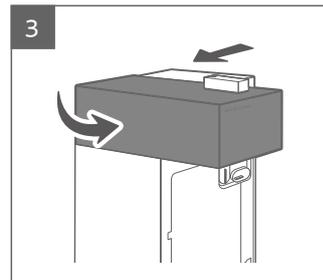
3 抽出口の向きを90度回転した後、トップカバーを内側へ移動させてください。
