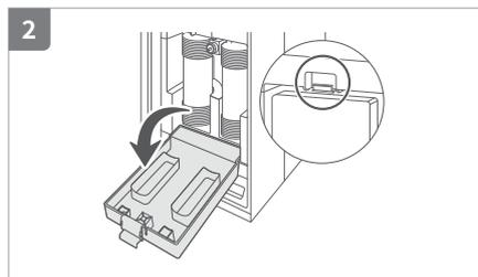
フィルターカバーのレバーを押して、カバーを開けます。
