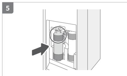
新しいナノトラップフィルターの白いキャップを外し、本体のフィルター接続部に平行に押し込んで取り付けます。
