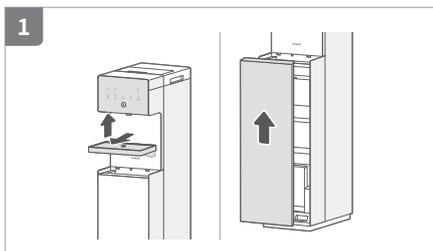
受け皿を手前にスライドさせてから、上に持ち上げて外します。前面カバーを上スライドさせて外します。
