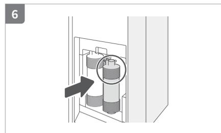
新しいプラスイノセンスフィルター (LR) の白いキャップを外し、本体のフィルター接続部に平行に押し込んで取り付けます。
