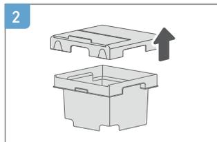
給水タンクカバーを上を持ち上げて取り外します。
