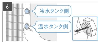
本体後ろのスクリーキャップとシリコンキャップを外し、冷水と温水をすべて排水してください。※①②の工程から時間が経過し温水が熱くなっている場合はやけどにご注意ください。
