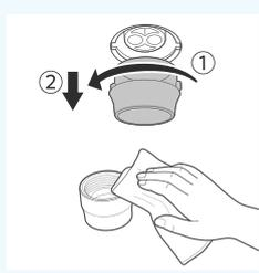
抽出口リングは左に回し、下に引き抜くと取り外せます。汚れたらすぐに清掃してください。乾いた柔らかい布などで拭いてください。汚れがひどい場合は、中性洗剤などで洗ってください。
