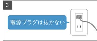
電源プラグは抜かず、冷温水スイッチはONのままにしてください。(本体内の水の鮮度を保ち、衛生状態を維持するため)
